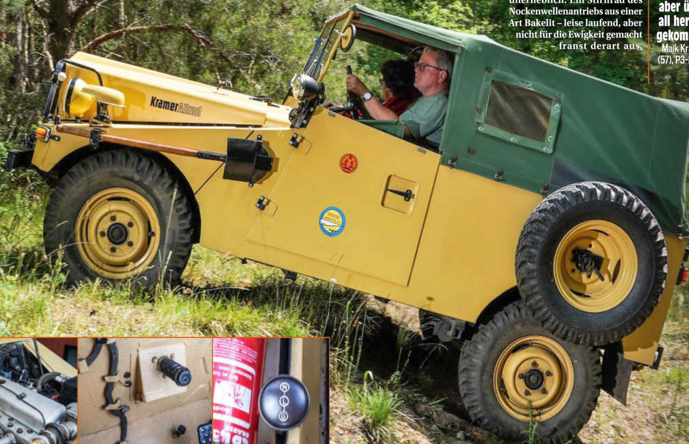
Fußschalter für Fernlicht (unten links) und die Zentralschmierung (oben rechts)
