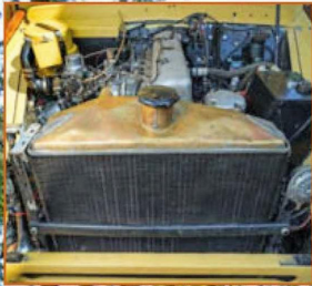
◀ Messingteil im Vorkriegsstil. Schwarzer Kasten rechts: das Ölreservoir der Trockensumpfschmierung
